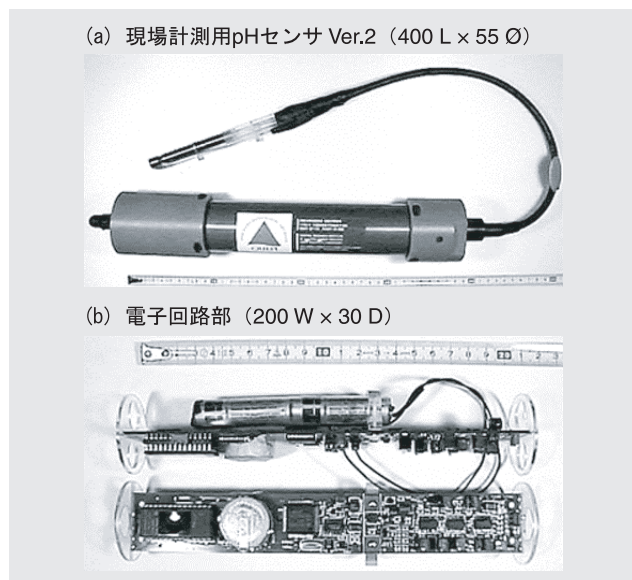
図1 ISFETを用いた現場計測用pHセンサ(Ver.2)
