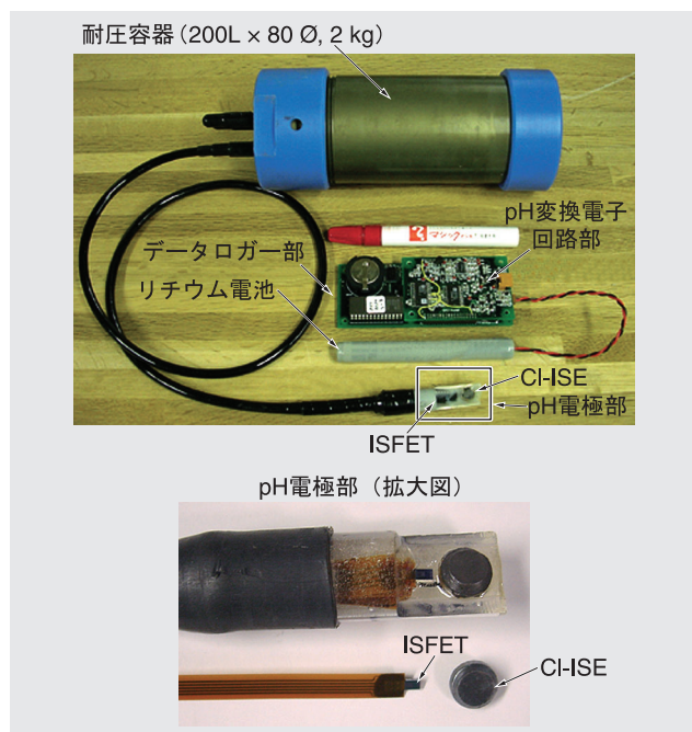
図5 新たに開発した現場計測用pHセンサ(Ver.3)及び電極部
